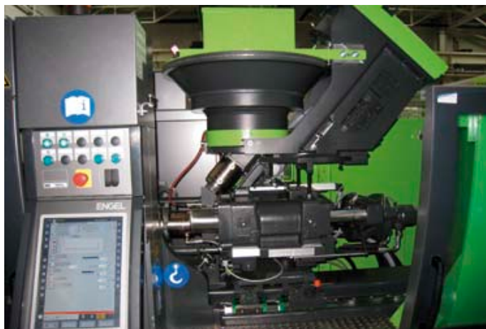
Abb. 5: Eine unterbrechungsfreie Materialzuführung ist beim Einsatz der neuen Drehfördereinrichtung Engel roto feeder – hier auf einer Engel victory 330/80 HCR – selbstverständlich.
