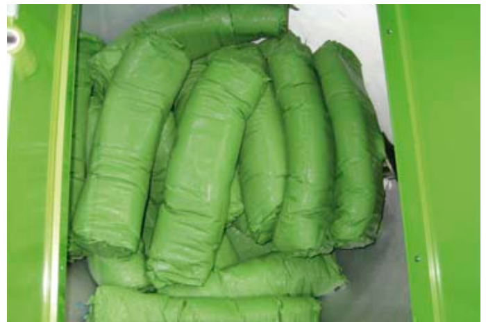
Abb. 4: Festsilicon kommt in Form von Riegeln, wie hier im Trichter der Drehfördereinrichtung Engel roto feeder, sowie in Streifen, Matten oder Granulat zum Einsatz.
