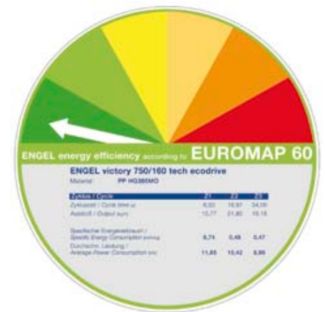
Abb. 7: Mit der Servohydraulik Ecodrive sind die Engel-Maschinen heute auf einem Höchstmaß der Energieeffizienz angelangt. Euromap 60 macht die Energieeffizienz herstellerübergreifend vergleichbar.
