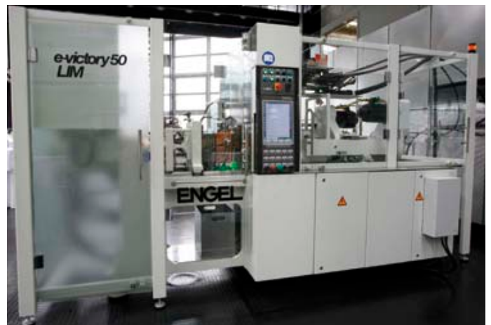
Abb. 6: LSR gewinnt in der Medizintechnik rasant an Bedeutung. Reinraumtaugliche Systemlösungen werden angeboten, zum Beispiel auf Basis einer Engel victory 80/50 LIM.
