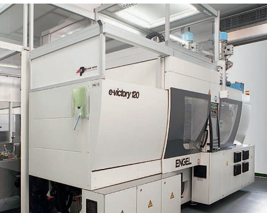
Mit Hilfe der Indexplattentechnik werden verschiedene Phasen des Spritzgießprozesses zeitgleich durchgeführt
