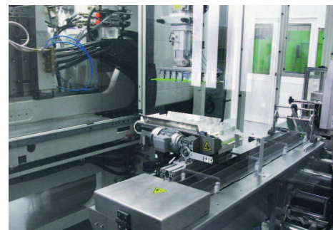
Der Roboter legt die Teile in die Zuführung der Verpackungsmaschine
