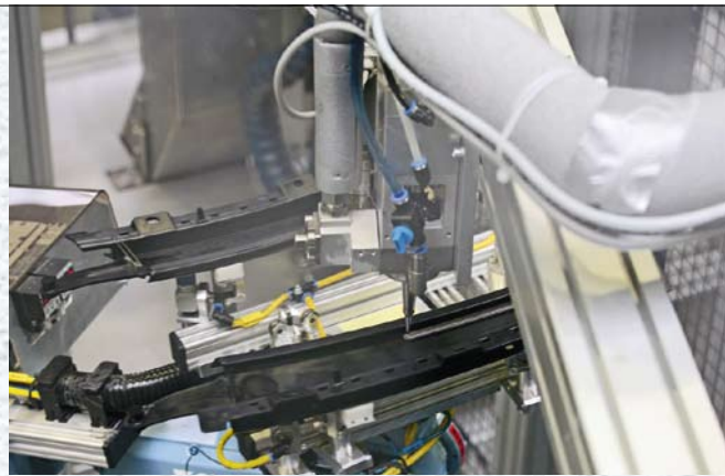
Nach einer Plasmavorbehandlung wird eine Dichtraupe aus PUR auf die Unterseite der Blenden aufgetragen.
