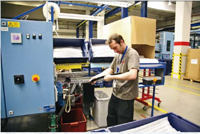
Die 3-Komponenten-Blenden verlassen montagefertig die Zelle. Ein Mitarbeiter kontrolliert die Qualität und verpackt die Blenden für den Transport.
