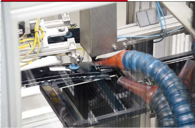
Der Filmguss wird mit Hilfe eines Lasers abgetrennt.
