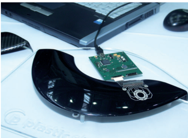
Im Clearmelt-Verfahren wird das Bauteil mit einem transparenten PUR überspritzt. Hier wurde unter der 0,5 mm dünnen Deckschicht ein Tastenfeld mit Schaltkreis integriert, dessen Funktionen durch eine sanfte Berührung der Oberfläche mit der Fingerspitze ausgelöst werden (Foto: Wolf)
