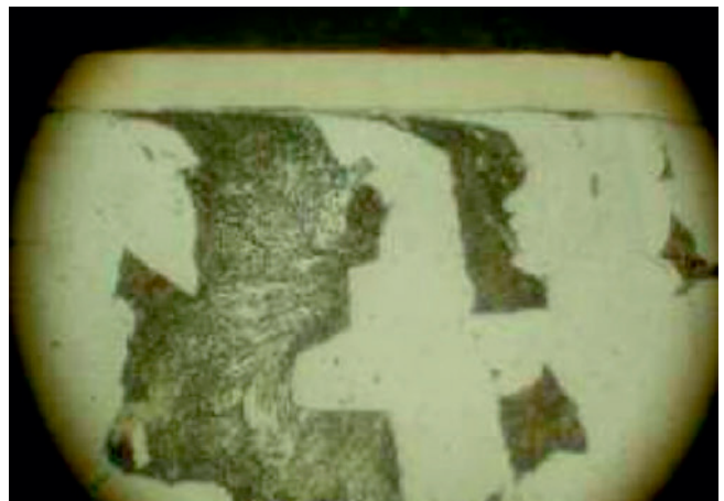
Bild 5. Die Probe links oben weist nach 60-minütiger Behandlung mit Chlorocleans keine Schäden auf. Rechts dargestellt ist ein Schnitt mit Auflichtmikroskop (60-fach vergrößert) zur Prüfung der Bindung Beschichtung/Matrix, der deutlich die glatte, durchgängig geschlossene Beschichtung zeigt
