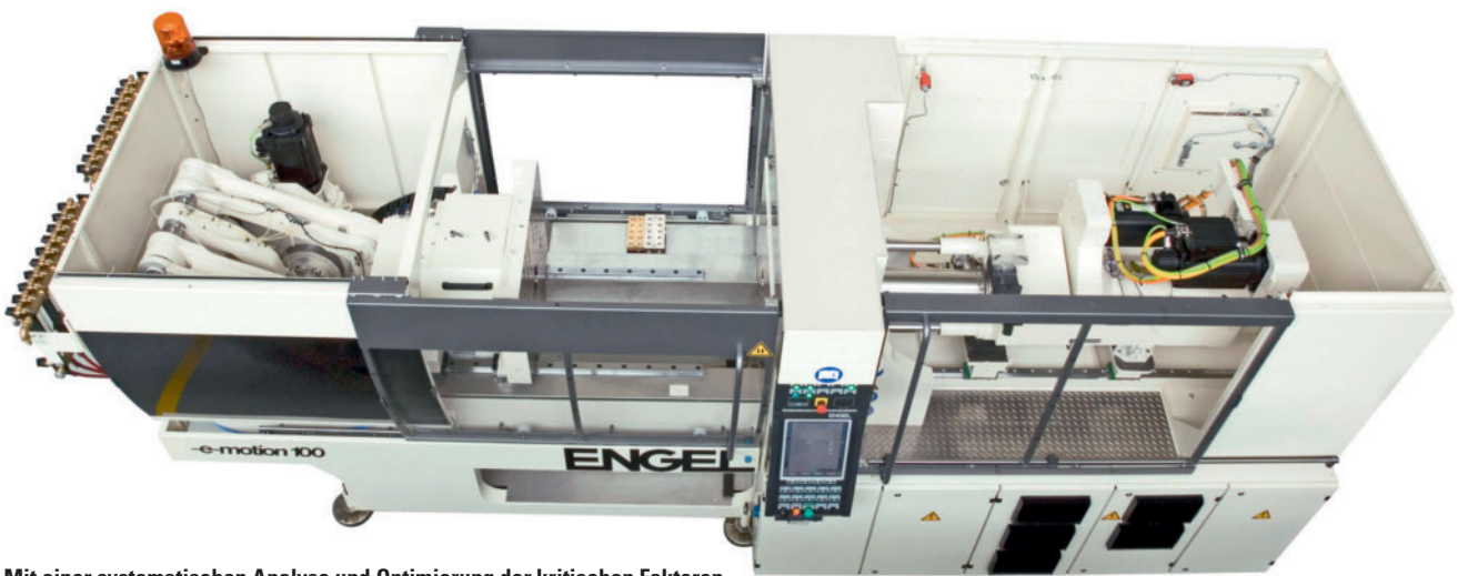
Mit einer systematischen Analyse und Optimierung der kritischen Faktoren gelingt es, ein reinraumtaugliches und zugleich wirtschaftliches Maschinenkonzept zu entwickeln: die reinraumtaugliche Engel e-motion 100 medical
