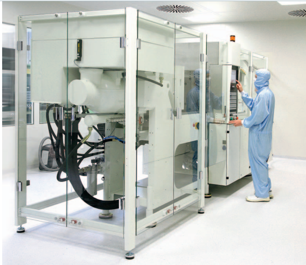
Die eigens für den Reinraum adaptierte Spritzgießmaschine integriert die beiden maßgeblichen branchenspezifischen Anforderungen in ihr Konzept: Reinheit und Präzision
