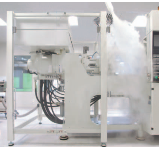
Bild 2. Durch die Verbesserung der Strömungseigenschaften im Bereich des Spritzgießwerkzeugs werden Turbulenzen minimiert und lokale Partikelkonzentrationen minimiert
