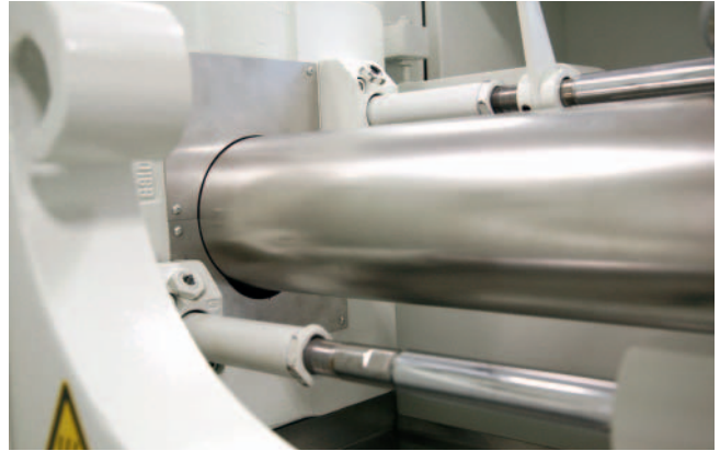
Bild 5. Das patentierte GMP-Massezylinderkonzept verhindert Emissionen in den Reinraum
