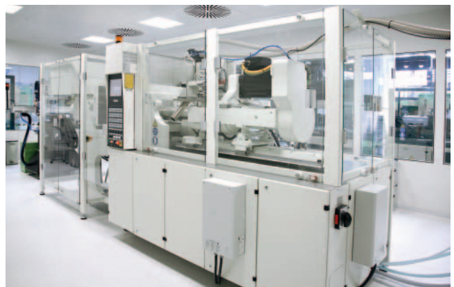
Bild 5. Das patentierte GMP-Massezylinderkonzept verhindert Emissionen in den Reinraum
