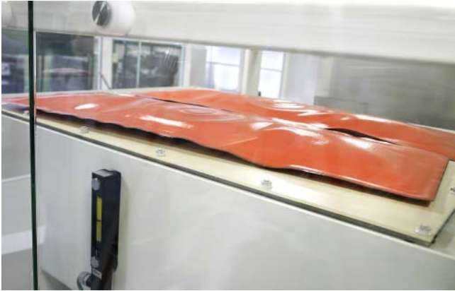
Bild 4. Durch die Kapselung des Tanks mit Balgen arbeitet die gesamte Hydraulik als geschlossenes System
