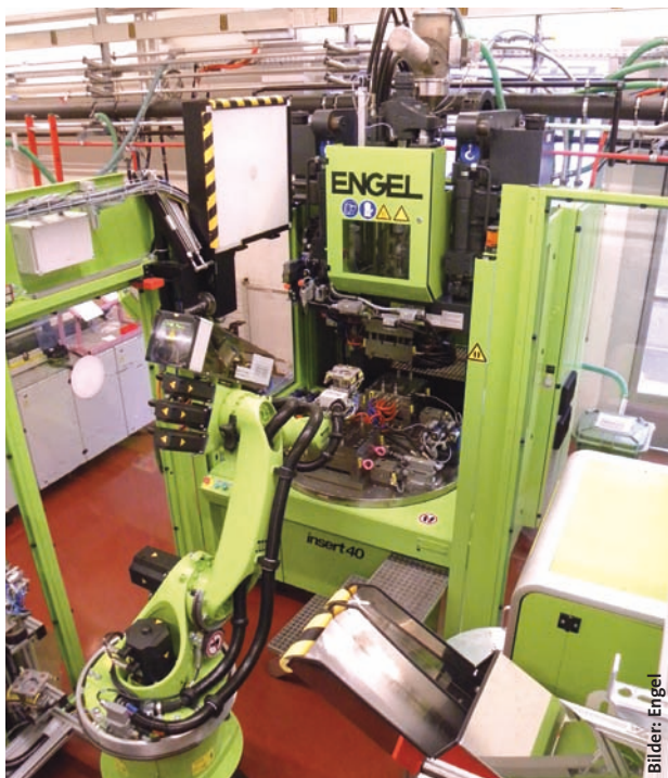
Die Herstellung des Pushfit-Klemmrings erfolgt auf einer Engel Insert 80V/40-Maschine. Der Roboter legt die Bleche kameragesteuert lagerichtig in die Form ein.
