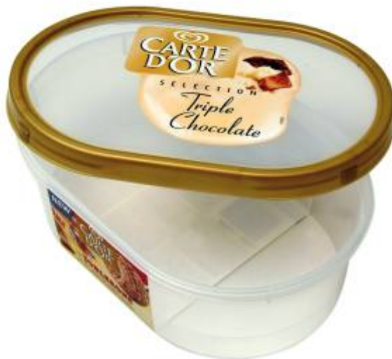
Eisbecher mit 1,1 Liter Volumen aus Polypropylen, hergestellt in einem 4+4-fach-Etagenwerkzeug auf einer Schnellaufmaschine ENGEL speed 500/90
