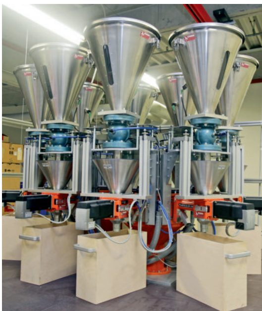
Bild 3. Die beiden Plastifiziereinheiten des e-compounders sind jeweils mit vier Mischanlagen kombiniert. Mit dieser Konfiguration hat die Maschine das Potenzial, bis zu acht verschiedene Rohstoffe dosieren zu können (Foto: Engel)
