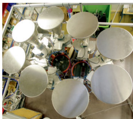
Bild 3. Die beiden Plastifiziereinheiten des e-compounders sind jeweils mit vier Mischanlagen kombiniert. Mit dieser Konfiguration hat die Maschine das Potenzial, bis zu acht verschiedene Rohstoffe dosieren zu können (Foto: Engel)
