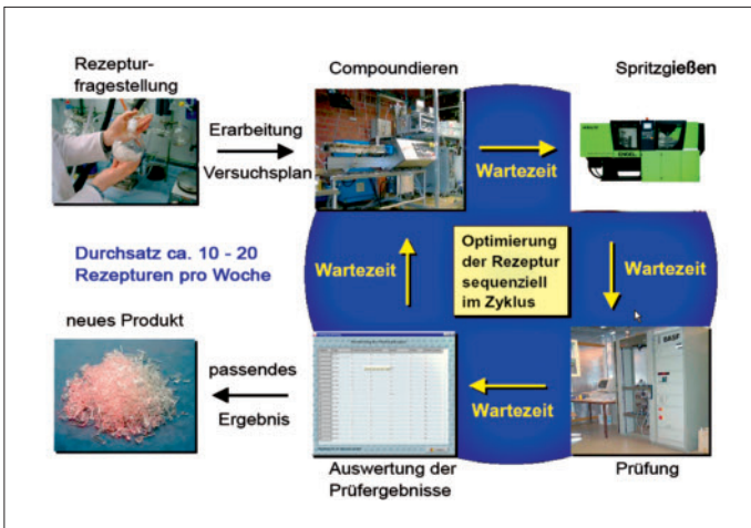
Bild 2. Ausgangspunkt der Entwicklung war die Suche nach einer Alternative zur traditionellen Rezeptentwicklung aus vier Einzelprozessen (links). Das alternative System (rechts) beschleunigt den Entwicklungs- und Prüfprozess. Einen wesentlichen Anteil daran hat die Integration von Compoundieren und Plastifizierung in einer Spritzgießmaschine (Grafik: Polymaterials)
