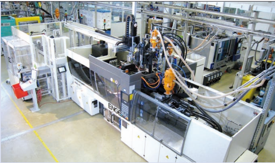
Die kompakte Produktionszelle auf Basis einer holmlosen Victory 180 mit vier Spritzaggregaten (zwei davon in L-Stellung an der Maschinenrückseite), die über einen ERC 33-1F Linearroboter mit der Palletierstation kombiniert ist, ermöglicht eine hohe Funktionsintegration .
