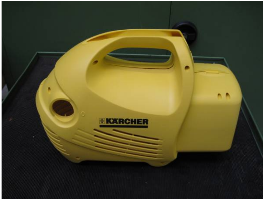
Bild 2: Gehäuseteil von Kärcher – Hergestellt auf einer ENGEL e-motion 500 T
