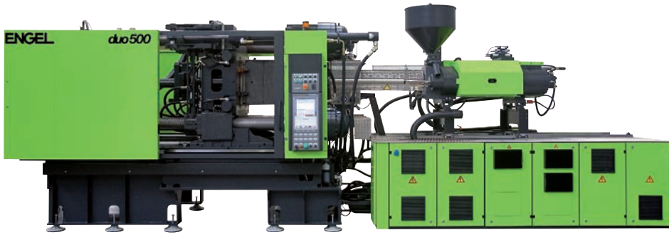
Bei einer minimalen Zykluszeit von 39,8 Sekunden verbrauchte die Engel duo 500 im Vergleichstest von IPG 0,458 kWh/kg.
