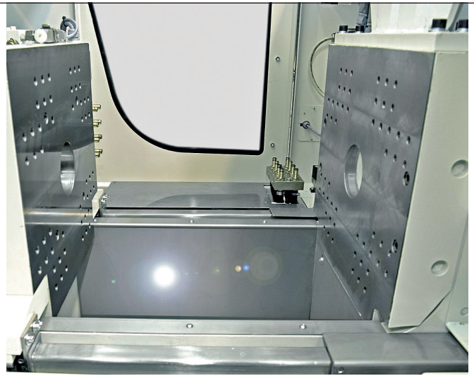
Die holmlose Schließereinheit bietet im Reinraum Vorteile.
