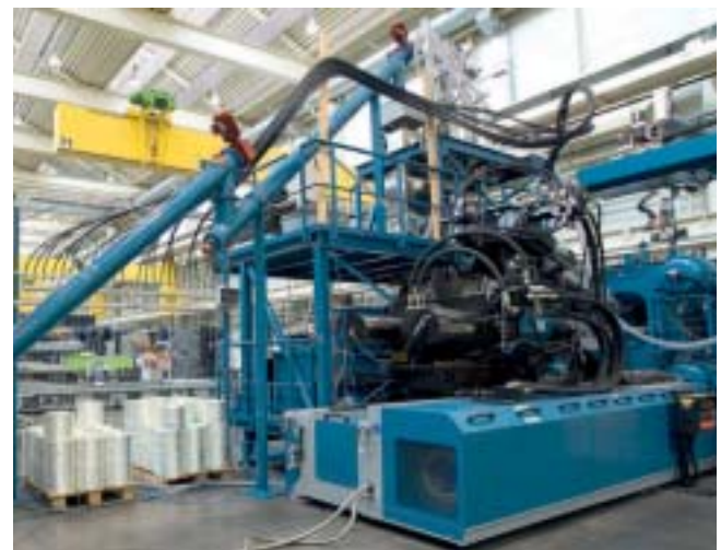
Detailansicht der beiden Plastifiziermodule: Links die Extrusionsanlage mit „Stand-Alone“ Förder- und Dosieranlage, rechts die Plastifiziereinheit der Spritzgießmaschine. Damit besteht die Möglichkeit, letztere bei Bedarf ohne technische Einschränkungen unabhängig von der Compoundieranlage zu betreiben
