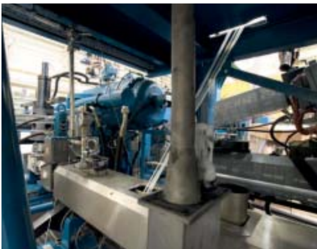
Extrusionsanlage mit der Einzugszone für die Glasfaserrovings und dem Vakuumanschluss für die Entgasung. Am vorderen Zylinderende befindet sich der Speicherkopf zur Zwischenspeicherung der Schmelze beim Einspritzen. Im Hintergrund (rechts im Bild) sind die Plastifizierzylinder der Spritzgießmaschine zu sehen
