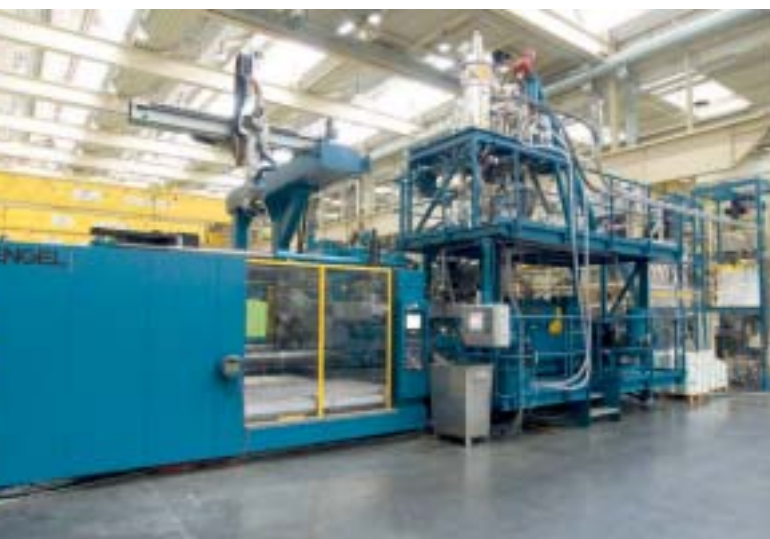
Spritzgießen mit integriertem Compoundieren: Der modulare Aufbau der Anlage beinhaltet eine Standard-Großmaschine Duo und einen Serien-Doppelschneckenextruder inklusive den Einrichtungen zur Materialdosierung und -zuführung. Zur Handhabung der Formteile wird ein Engel ERC-Linearroboter samt individuell abgestimmter Peripherie eingesetzt (Bilder: Engel)
